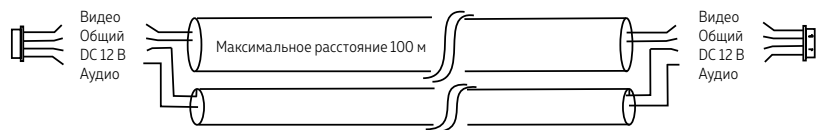
Рис. 9 Комбинированный видеокабель для подключения видеодомофона
